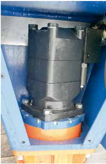
Der Hydraulikmotor ist in dem konischen Gehäuse sicher untergebracht. Ein Überdruckventil schützt den Antriebsstrang vor Überlastung.
